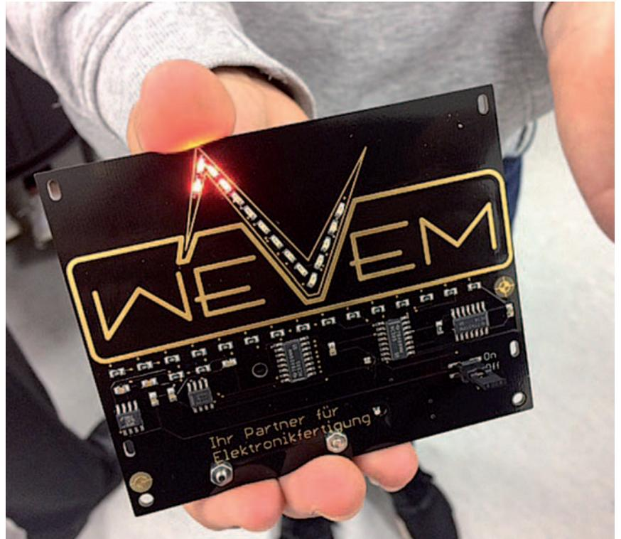
Eine vom Roboter sowie teils selbst bestückte Platine mit Logo der WE-EM Nachrichtentechnik GmbH. Foto: Kreis Mettmann
